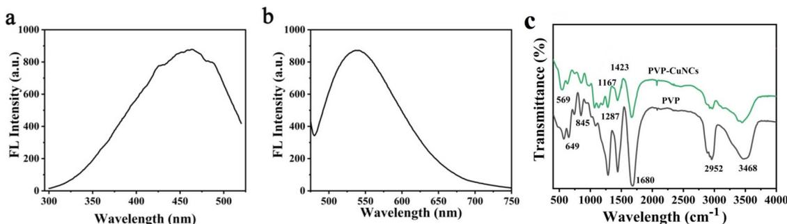
Fig. 4. a: The fluorescence excitation diagram of CuNCs@PVP; b: The fluorescence emission diagram of CuNCs@PVP; c: The infrared spectrum of PVP and CuNCs@PVP.
